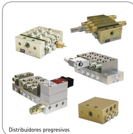
SKF ProFlex. Sistemas de lubricación progresiva diseñados para aceite, grasa fluida y grasa consistente. El sistema mostrado corresponde a grasa consistente.
